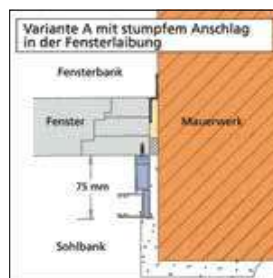
Detail: Fensteranschlag mit RG-Führungsschienen-System
